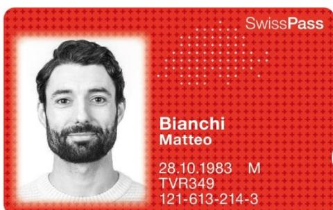
È una tessera plastificata, dotata di chip elettronico RFID, su cui è memorizzato un numero che consente di verificare l'abbonamento. Sulla tessera non è quindi stampato nessun riferimento alla prestazione acquistata (tipo di abbonamento e data di validità). Tramite la tecnologia RFID il personale di controllo può visualizzare sul proprio dispositivo tutte le informazioni necessarie.
